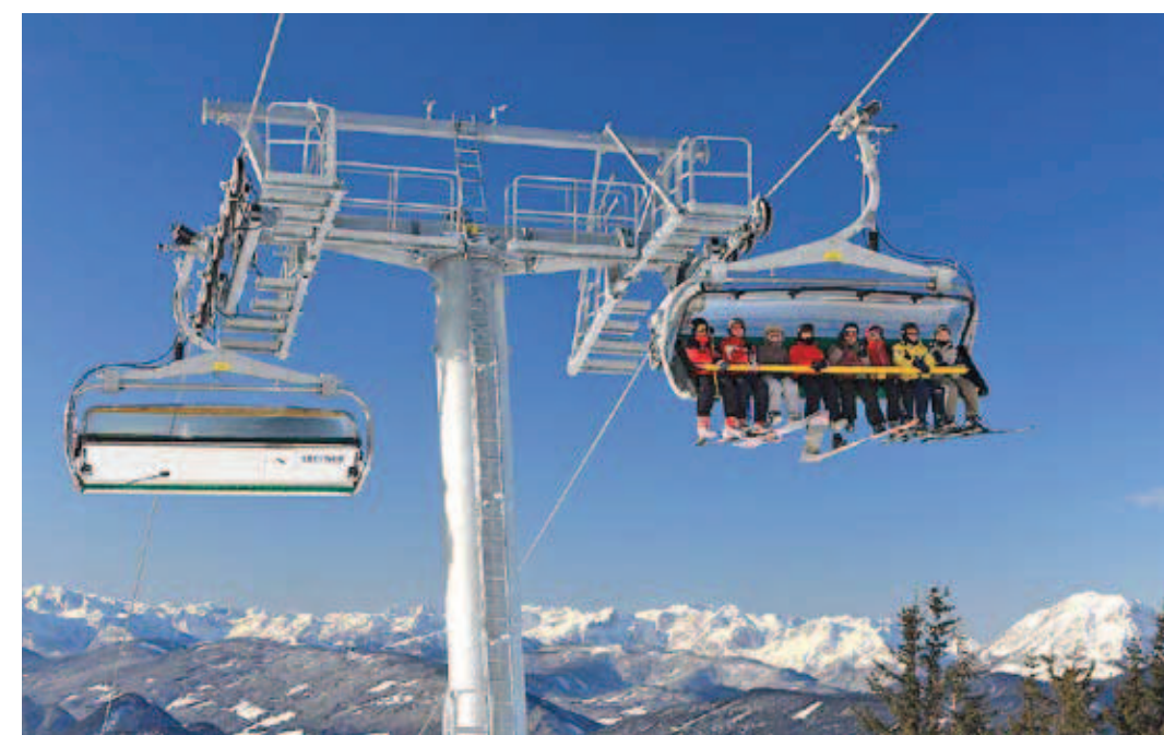
Die automatisch verriegelbaren Sicherheitsbügel bieten einen höheren Sicherheitsfaktor vor allem beim Transport von Kindern.
